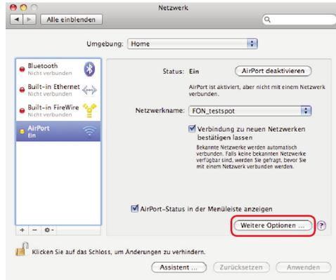
4. Klicken Sie auf den Reiter **TCP/IP** und stellen Sie sicher, dass die Option **IPv4 konfigurieren** auf **DHCP** steht.
