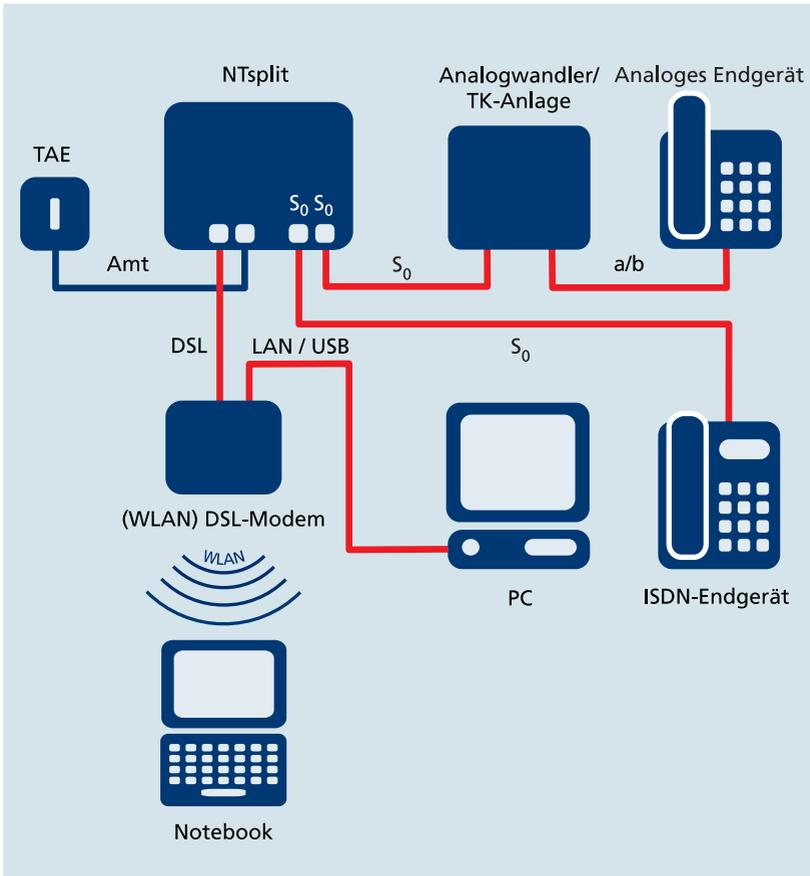
Abbildung 2: Endgeräte am NTsplit anschließen
