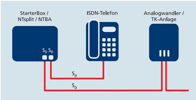
Abbildung 4: ISDN-Endgeräte an StarterBox/NTsplit/NTBA anschließen
