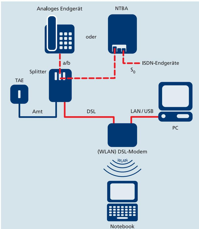
Abbildung 8: Endgeräte am T-Com Anschluss installieren
