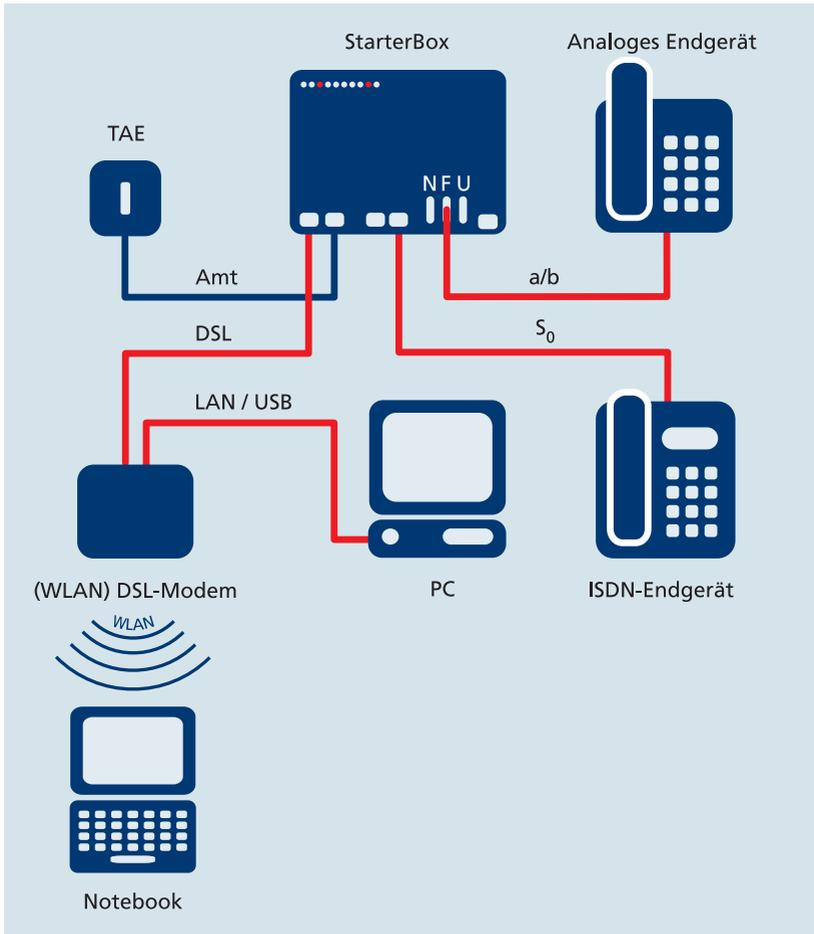
Abbildung 1: Endgeräte an der StarterBox anschließen
