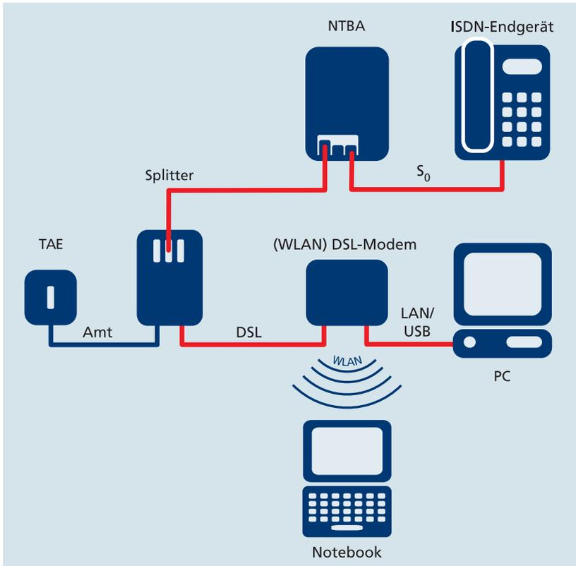
Abbildung 3: Endgeräte am NTBA und am Splitter anschließen
