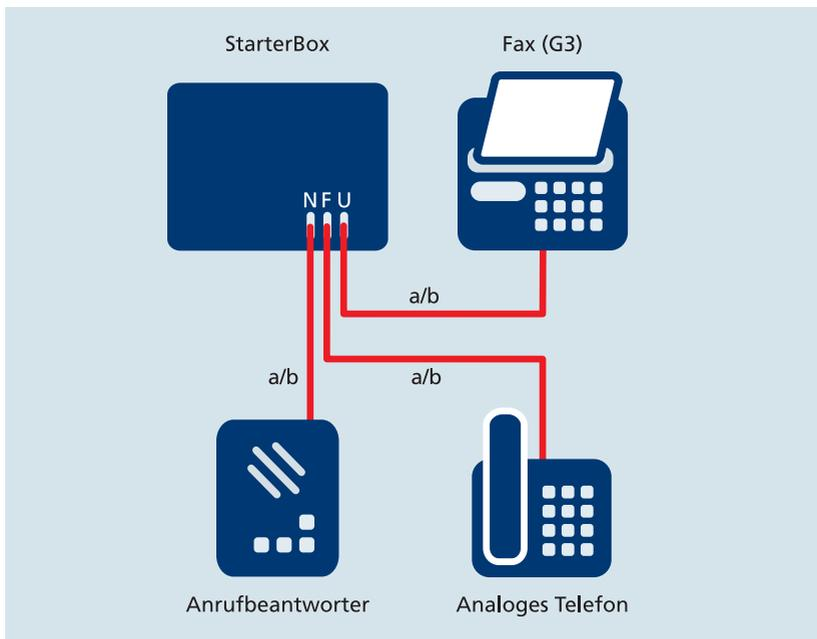
Abbildung 6: Analoge Endgeräte an der StarterBox anschließen
