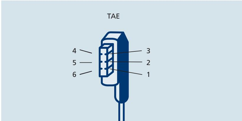
Abbildung 16: TAE-Stecker für analoge Endgeräte
