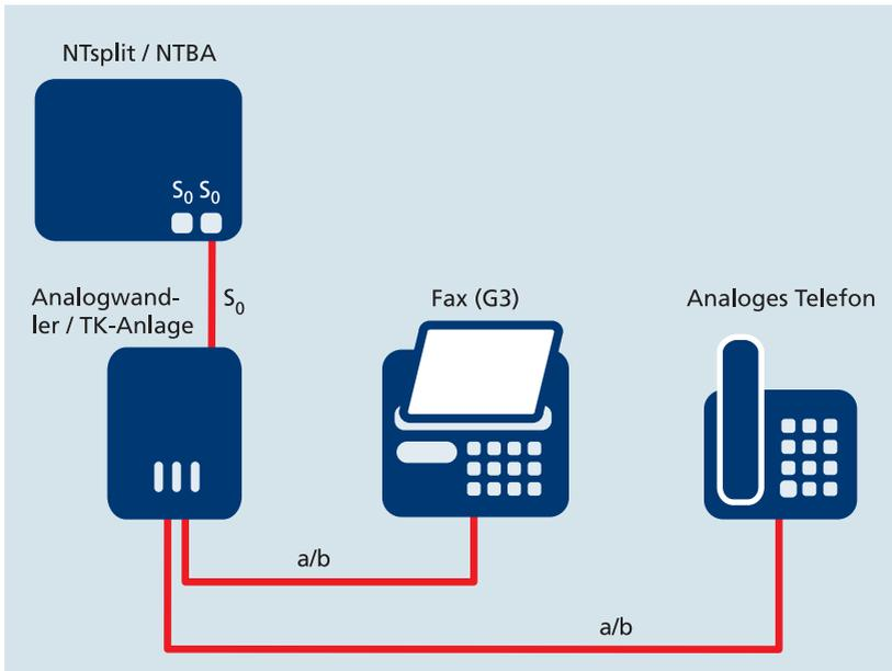
Abbildung 7: Analoge Endgeräte am NTsplit/NTBA anschließen
