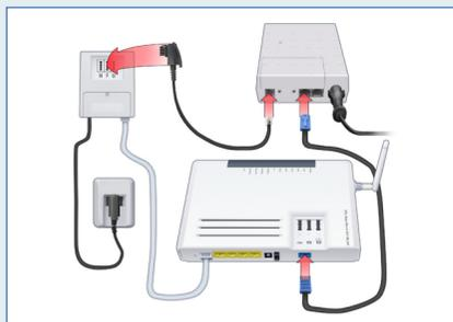
3. Schließen Sie jetzt das mitgelieferte Netzteil an Ihre DSL-EasyBox an und stecken Sie das Netzteil in die Steckdose. Danach schalten Sie das Gerät über den ON/OFF-Schalter ein.
