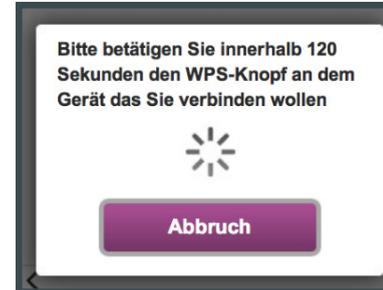
Bei der WPS-Verbindung werden Sie aufgefordert, innerhalb von 120 Sekunden den WPS-Knopf Ihrer EasyBox und Ihres WPS-fähigen Gerätes zu betätigen, um die Verbindung dieser Geräte zu veranlassen.
