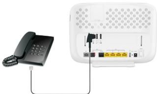
Aktivieren Sie Ihre EasyBox **am DSL-Anschluss** mit Hilfe eines Analog- oder ISDN-Telefons
