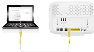
Aktivieren Sie Ihre EasyBox **am DSL-Anschluss** mit Hilfe eines über LAN-Kabel verbundenen Computers
