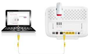
Aktivieren Sie Ihre EasyBox **mit einem UMTS-Stick** mit Hilfe eines über LAN-Kabel verbundenen Computers
