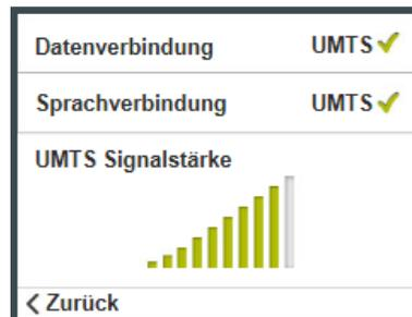
Das Internet-Menü des LC-Displays zeigt im UMTS-Modus den Daten- und Sprachverbindungsstatus, wie auch die aktuelle UMTS-Signalstärke an.
